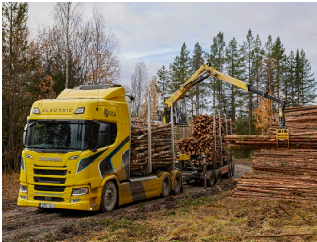
SCAs första eltimmerbil togs i drift 2022 och har ingen kran, utan körs mellan en virkesterminal och SCAs pappersbruk. Eltimmerbilen som driftsattes 2024 har däremot kran och hämtar virke i skogen för transport till en virkesterminal.
