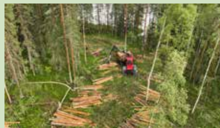
Här har skotaren backat in för att kunna lasta på virke på vägen ut. På så sätt är skotaren som lättast där marken är som svagast.
