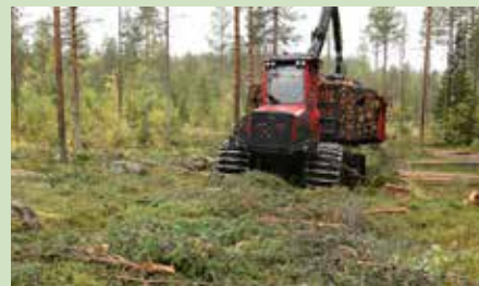
Genom att välja rätt ställe för vägarna på avverkningstrakten och genom att risa huvudbasstråken kan man avverka och köra ut virke utan att skada mark och vatten.
