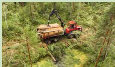
Att få till bra överfarter över bäckar och vattendrag är en central del i SED. Det är viktigt att både skydda själva vattendraget och marken intill. Här har avverkningslaget byggt en bro med hjälp av virke och ris från avverkningen.
