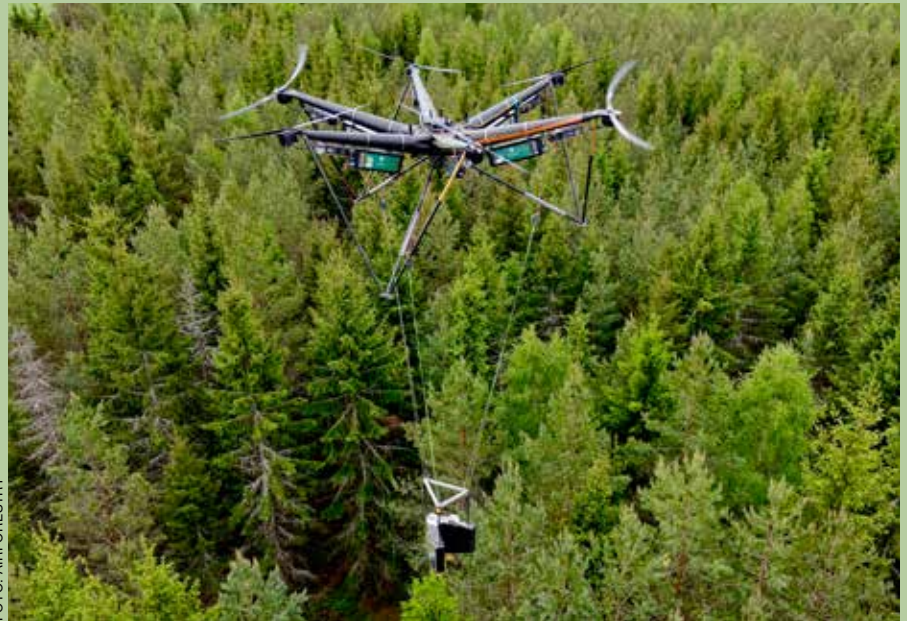
AirForestrys system kombinerar autonom flygning med ett specialiserat skördaraggregat, som är utvecklat specifikt för gallring från luften.
