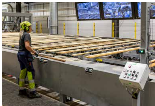
Bollsta sågverks nya CT-scanner följer stockens resa genom sågverket.
