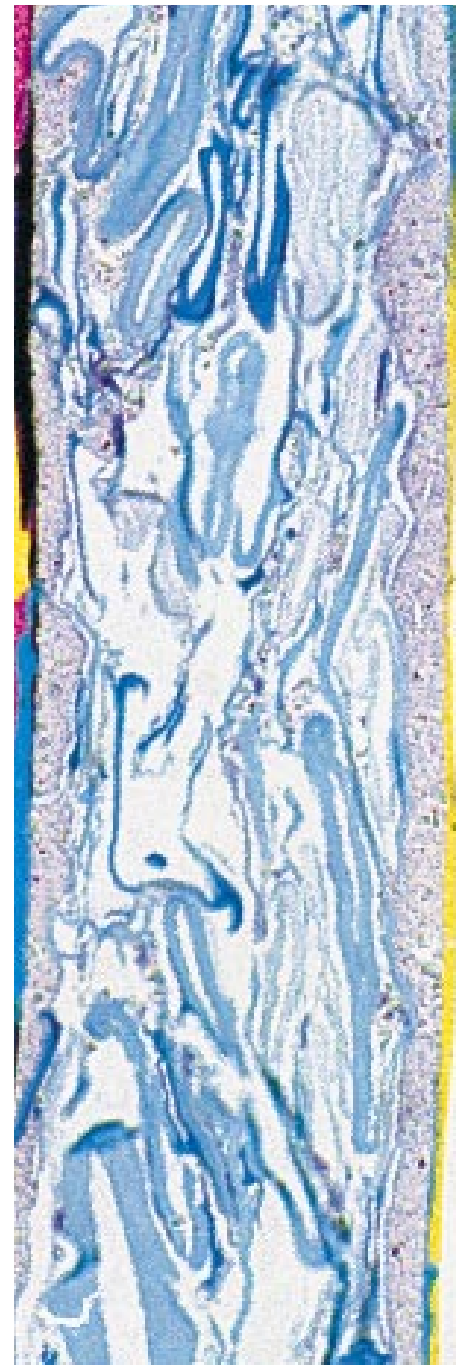
Tvårsnitt av ett 0,06 mm tjockt LWC-papper. Fotot är taget med hjälp av ljusmikroskop och ger en bild av papperets komplexitet. De olika färgerna visar mekaniska och kemiska fibrers fördelning (mörkblå respektive ljusblå färg), bstrykningskiktet (ljusröd) och tryckytan (cyan, magenta, gul och svart). Metoden används vid bedömning bland annat av papperets hållfasthet och ytegenskaper.
