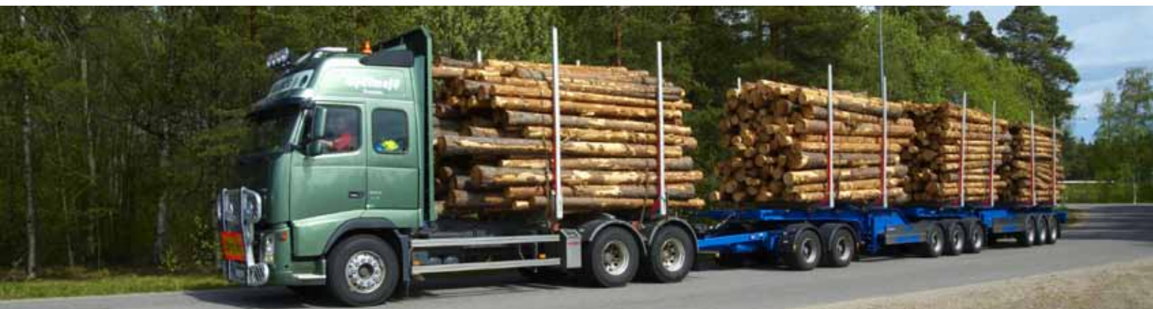
ETT (En Trave Till) är ett svenskt projekt som innebär att man lastar fyra travar på lastbilarna istället för tre. Därigenom minskas dieselförbrukning, koldioxidutsläpp, vägslitage och transportkostnader.
