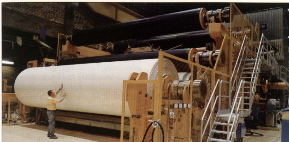
Den nya LWC-maskinen i Ortviken togs planenligt i drift i januari 1996 och ökar brukets kapacitet för LWC med 230.000 ton till 410.000 ton per år. Teknologin, som utvecklats inom SCA, har resulterat i en högkvalitativ produkt.
