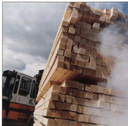
Under året lanserades Relax-torkade trävaror där en nyutvecklad torkteknik med ånganvändning ger spänningsfritt och sprickfritt virke.
