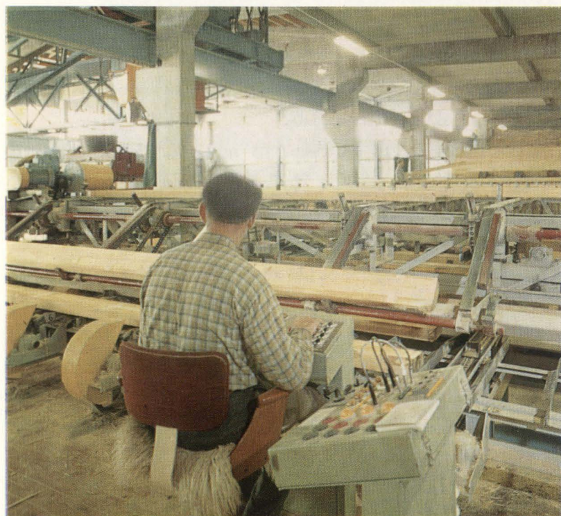
Tunadals sågverk tog hösten 1963 i bruk den nya torkanläggningen med tillhörande strölägnings- och kapningsmaskineri, var- vid kapaciteten ökades till 27 000 stds (bild från sorteringen till vänster).
