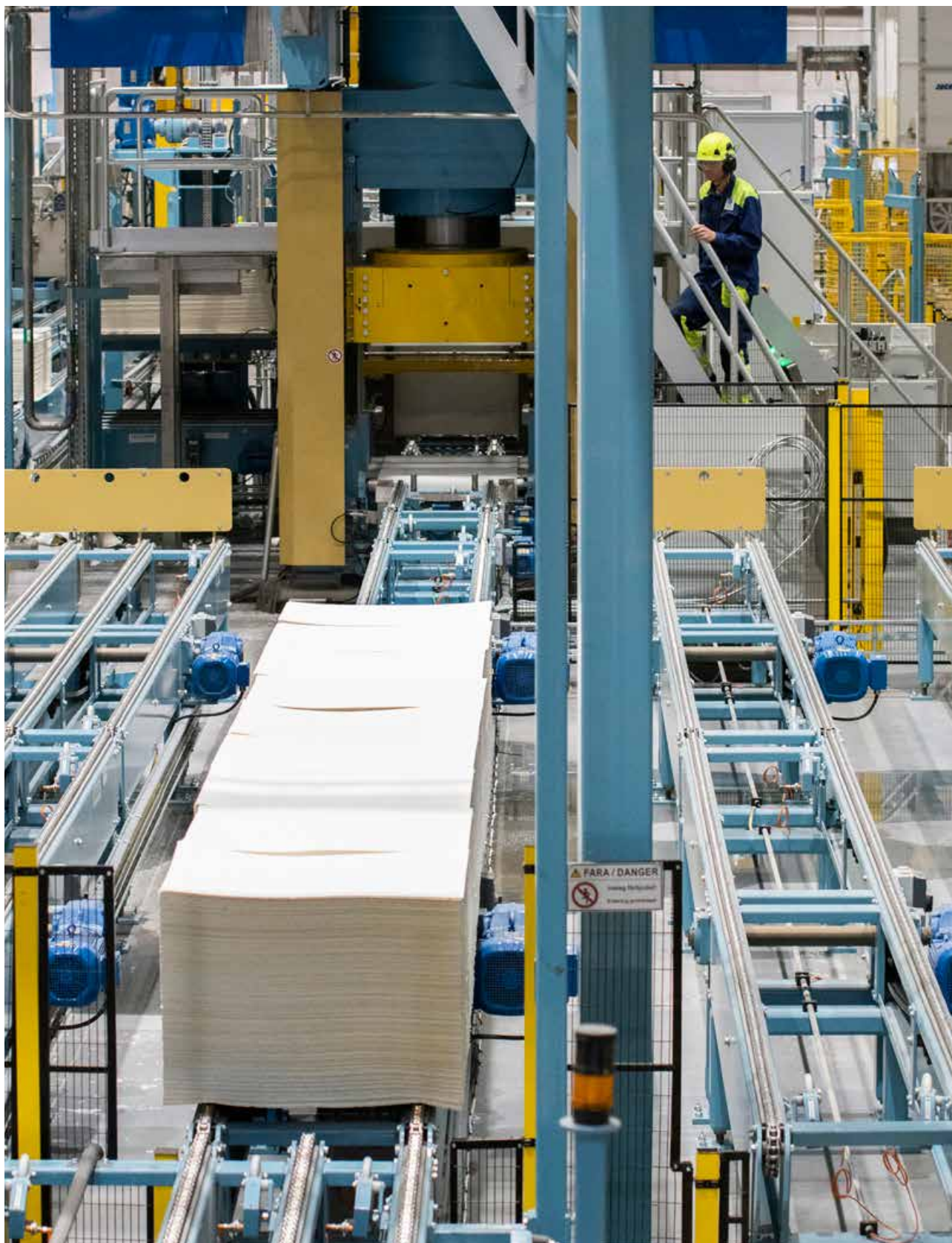
I den nya torklinjen skärs massan till ark, balas och emballeras.
