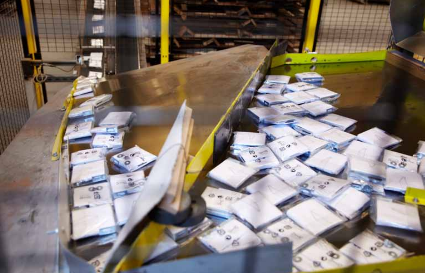
Skruvpåsarna matas fram, i rätt hastighet och antal, för att fästas på varje hyllplan.
